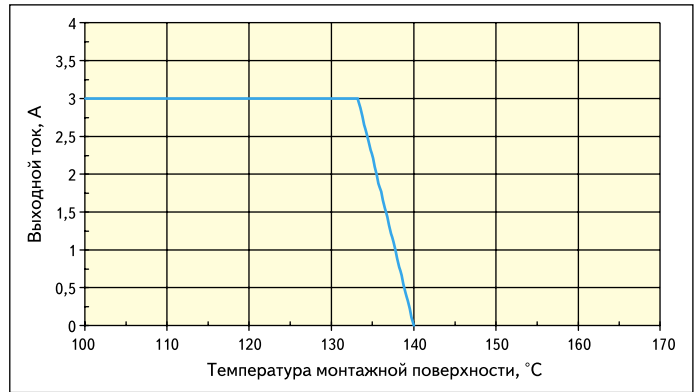
Рис. 5. Зависимость тока нагрузки от температуры корпуса стабилизатора без понижения мощности при максимальном рассеивании
