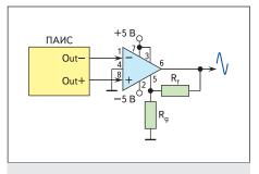
Рис. 8. Схема преобразования выходного униполярного дифференциального сигнала в биполярный сигнал с использованием ДУ AD8130
