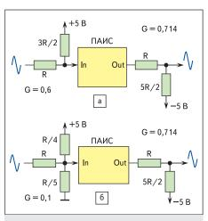
**Рис. 4.** Схемы смещения нуля входного и выходного сигнала с помощью делителей на резисторах
