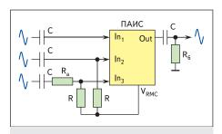
**Рис. 3.** Подключение ПАИС к источнику биполярного сигнала через конденсаторы
