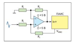
**Рис. 5.** Входной каскад, преобразующий биполярный сигнал в униполярный с постоянной составляющей, равной  $V_{RMC} = +2.0~B$
