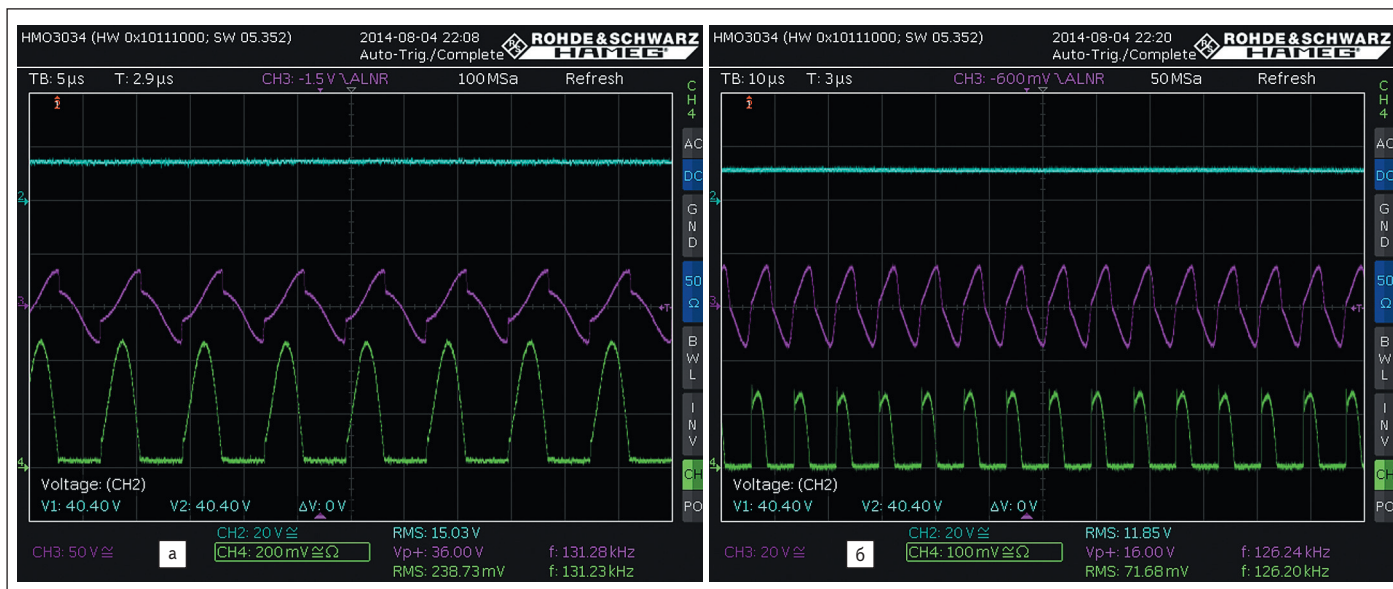
Рис. 6. Осциллограммы, соответствующие измерениям для выбранных вариантов сочетания катушек индуктивности: а) вариант № 1, Тх-WE #760 308 101 302, L — 5,3 мкГн; б) вариант № 2, Тх-WE #760 308 104 113, L — 12 мкГн
