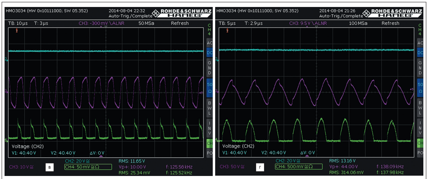
Рис. 6. Осциллограммы, соответствующие измерениям для выбранных вариантов сочетания катушек индуктивности: в) вариант № 3, Тх-WE #760 308 110, L — 24 мкГн; г) вариант № 4, Тх-TDK #WT-505060-8K2-LT, L — 5 мкГн
