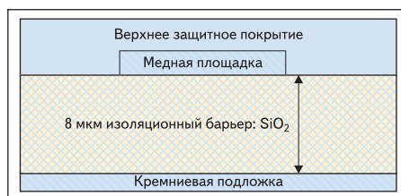
Рис. 1. Структура емкостного изолятора (один конденсатор)
