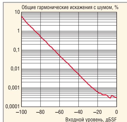
Рис. 8. Зависимость общих гармонических искажений и шума микросхемы DSD1792A от уровня входного сигнала
