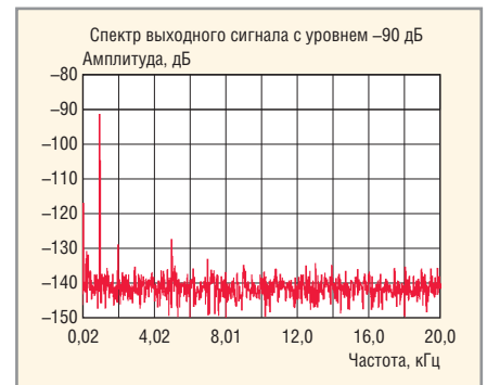
Рис. 5. Спектры выходного сигнала микроконтроллера PCM1704
