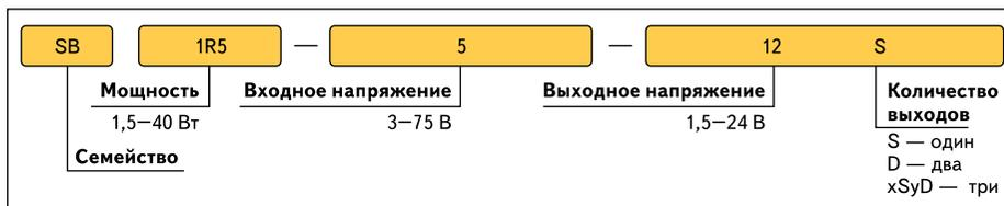
Рис. 8. Маркировка DC/DC-преобразователей компании Arch
