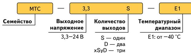
Рис. 4. Маркировка AC/DC-преобразователей для медицинского применения
