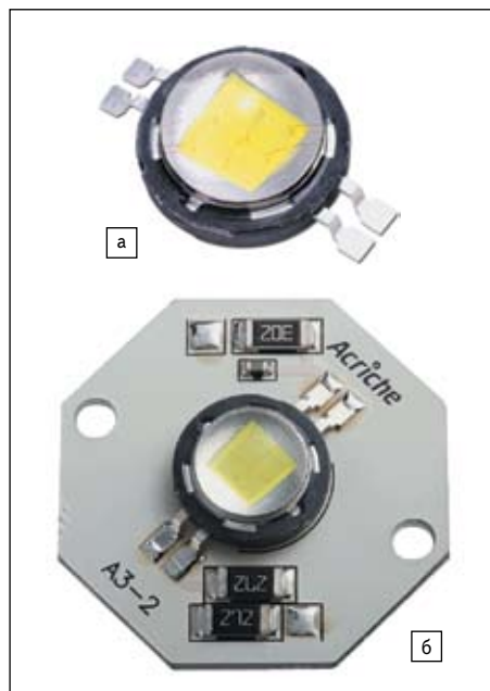
Рис. 2. Модели Acrіche: а) дискретный диод без подложки; б) на подложке типа «восьмиугольник»
