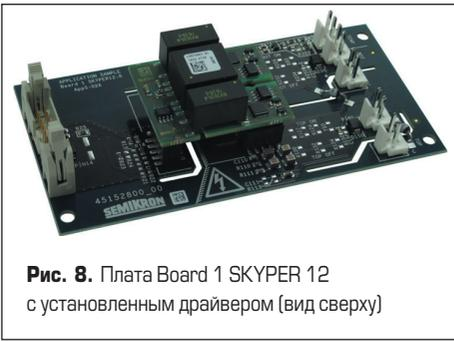
Рис. 8. Плата Board 1 SKYPER 12 с установленным драйвером (вид сверху)
