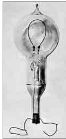
Рис. 11. Одна из первых ламп с угольной нитью накаливания
