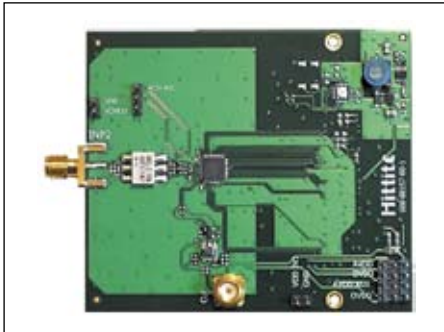
Рис. 8. Печатная плата для тестирования микросхемы АЦП HMCAD1051-80
