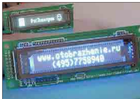
Рис. 2. Индикаторный модуль GU140X16G-7042 с синим фоном. Для сравнения рядом показан модуль с выключенным фоном
