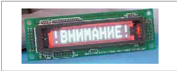
Рис. 4. Индикаторный модуль GU140X16G-7042 с красным фоном
