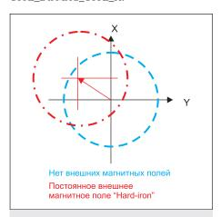
Рис. 9. Искажение геомагнитного поля под воздействием постоянного внешнего магнитного поля hard-iron
