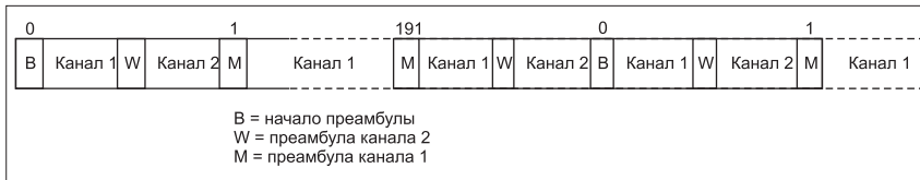
Рис. 7. Формат блока в интерфейсе SPDIF
