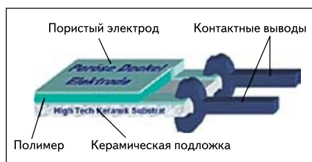
Рис. 1. Внутренняя структура датчика влажности
