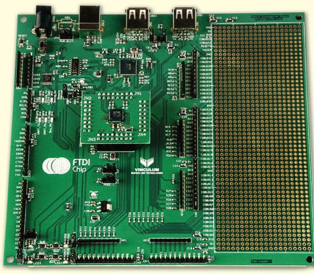
**Рисунок 8** Отладочная плата V2-Eval с модулем V2-Eval-Ext
