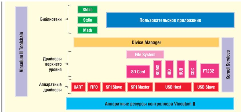
**Рисунок 7** Структура модели программного обеспечения Vinculum II
