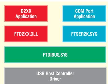
**Рисунок 3** Структура комбинированного драйвера аппаратных мостов FTDI
