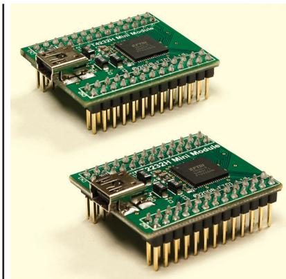
**Рисунок 1** Отладочные модули FT2232H Mini Module и FT4232H Mini Module
