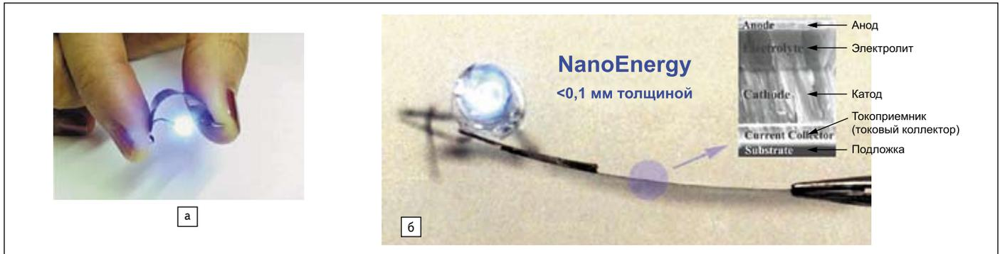
Рис. 13. Тончайшая перезаряжаемая батарея NanoEnergy от Front Edge Technologies, питающая синий светодиод, на основе электролита LiPON (технология ORNL): а) общий вид; б) вид с SEM-изображением
