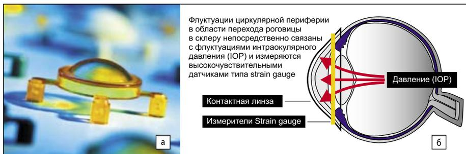
Рис. 12. Контактные диагностические МЭМС-линзы Triggerfish от Sensimed (на рынке — с лета 2011 года): а) внешний вид; б) принцип работы
