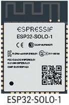
ESP32-SOLO-1 | ESP32-SOLO-1 содержит ESP32 SoC, флэш-память, высокоточные дискретные компоненты и PCB-антенну, которая обеспечивает отличные радиочастотные характеристики в приложениях с ограниченным объемом | ESP32-S0WD | 18×25,5×3,1 | 38   | 4            | N/A          | Антенна PCB, 2 дБи | ESP32-DevKitC       |
