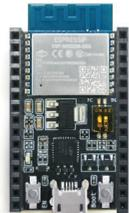
ESP8266-DevKitC | ESP8266-DevKitC — плата разработчика с MicroUSB-разъемом. Выпускается в двух модификациях: ESP8266-DevKitC-02D-F, ESP8266-DevKitC-02U-F, с различными модификациями модуля ESP-WROOM-02 на борту                                                                                     | Flash 4 Мбайт SPI + 4 Мбайт Flash HSPI | I/O, USB   |                        | ESP-WROOM-02D или ESP-WROOM-02U |
