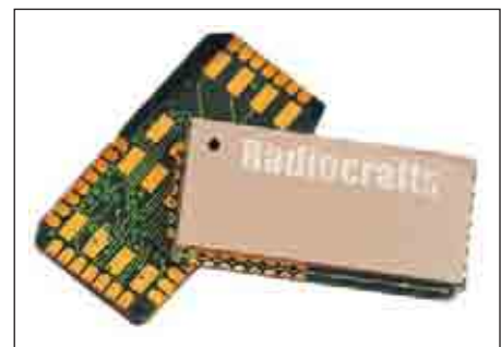
Рис. 1. Внешний вид малогабаритного модуля в корпусе для поверхностного монтажа
