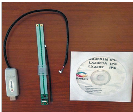
Рис. 8. Отладочный набор для тестирования схем сбора данных с датчиков линейного перемещения
