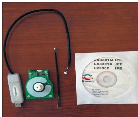
Рис. 9. Отладочный набор для тестирования схем сбора данных с датчиков углового перемещения
