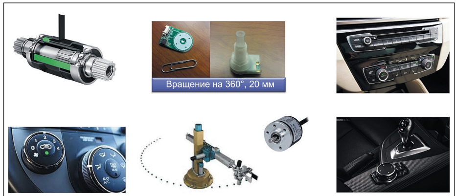
Рис. 4. Типовые примеры применения индуктивных датчиков для обнаружения вращательного движения
