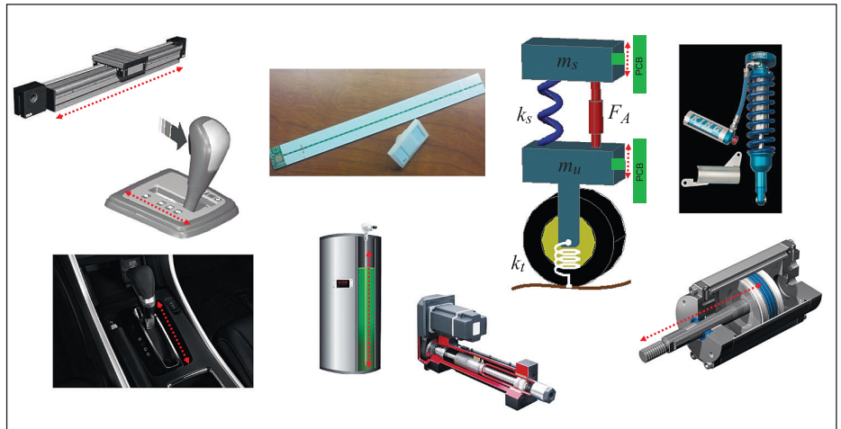
Рис. 6. Типовые примеры применения индуктивных датчиков для обнаружения линейного движения
