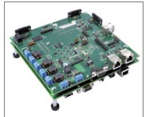
Рис. 15. Отладочный набор IDK для AM3359
