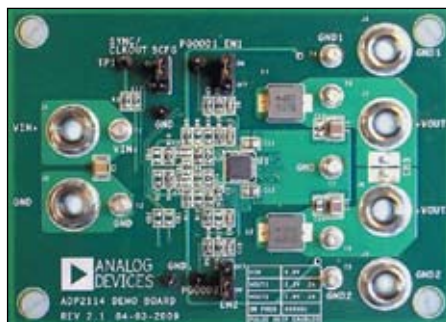
Рис. 15. Внешний вид отладочной платы для микросхемы ADP2114
