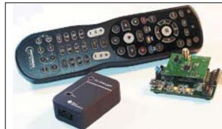
Рис. 4. Комплект разработчика RemoTI-CC2530DK
