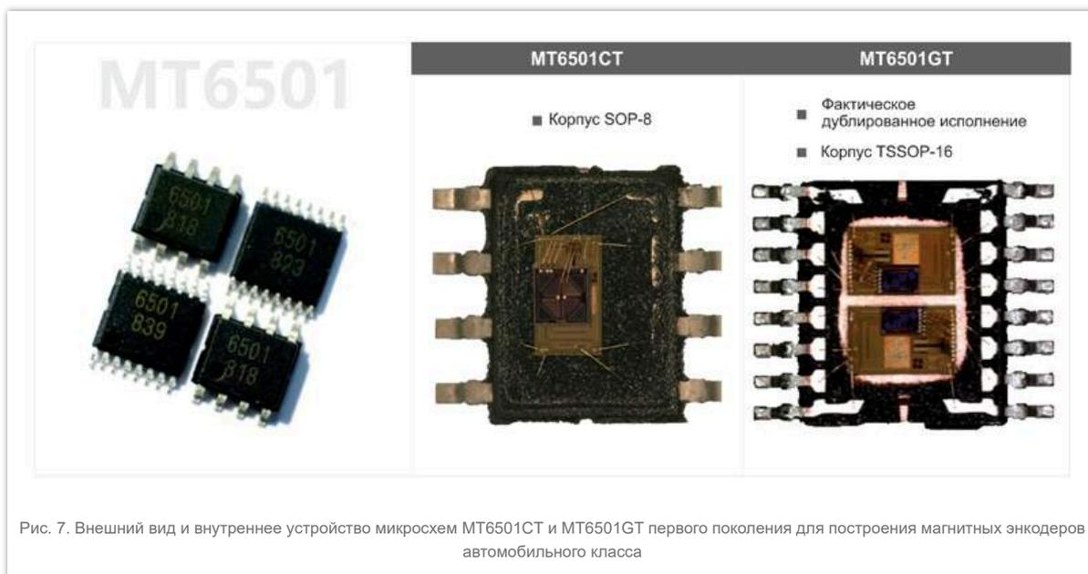
Рис. 7. Внешний вид и внутреннее устройство микросхем MT6501CT и MT6501GT первого поколения для построения магнитных энкодеров автомобильного класса
