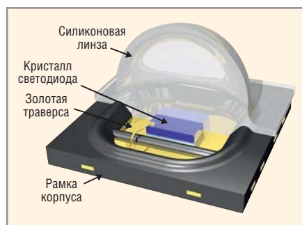
Рис. 2. Структура светодиодов серии OSOLON Black Series
