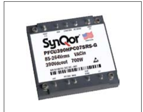
Рис. 5. Внешний вид модуля KKM PFCQor (версия без фланцев)
