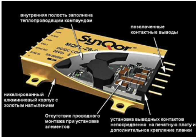
Рис. 4. Корпусирование по технологии QorSeal
