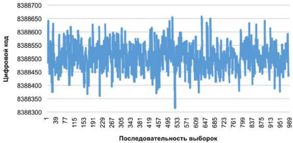
Рис. 5. Шум MS5194T: встроенный ИОН, частота выборки 16,7 Гц, Шор включен
