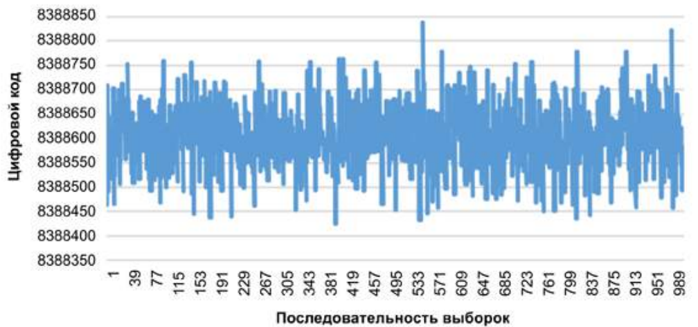
Рис. 6. Шум MS5194T: встроенный ИОН, частота выборки 16,7 Гц, Шор выключен
