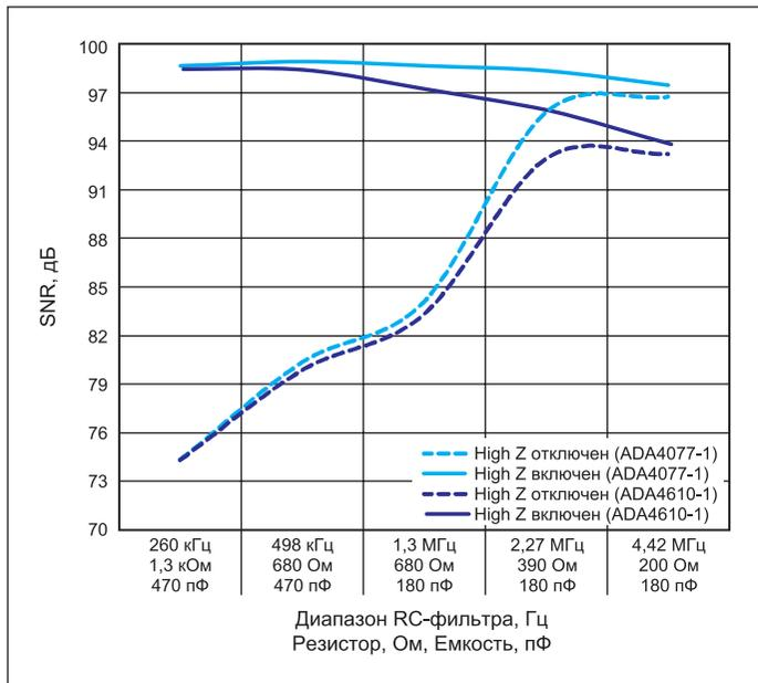
**Рис. 4.** Соотношение сигнал/шум для различных значений RC-фильтра на входе AD4003 при использовании драйверов (операционных усилителей) ADA4077-1 и ADA4610-1 во включенном и отключенном высокоимпедансном режиме ввода ( $U_{оп} = 5\text{ В}$ ,  $F_{вх} = 1\text{ кГц}$ )
