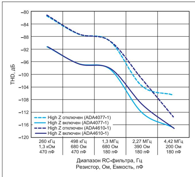
**Рис. 5.** Полный коэффициент нелинейных искажений для различных значений RC-фильтра на входе AD4003 при использовании драйверов (операционных усилителей) ADA4077-1 и ADA4610-1 во включенном и отключенном высокоимпедансном режиме ввода ( $U_{оп} = 5\text{ В}$ ,  $F_{вх} = 1\text{ кГц}$ )
