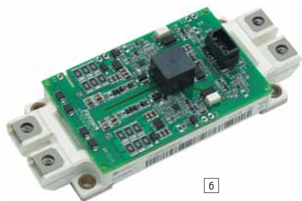
Рис. 1. а) Ядро драйвера, управляющее четырьмя параллельными модулями в конструктиве Econo-Dual через плату адаптера; б) plug-and-play-драйвер Firstack с модулем Econo-Dual
