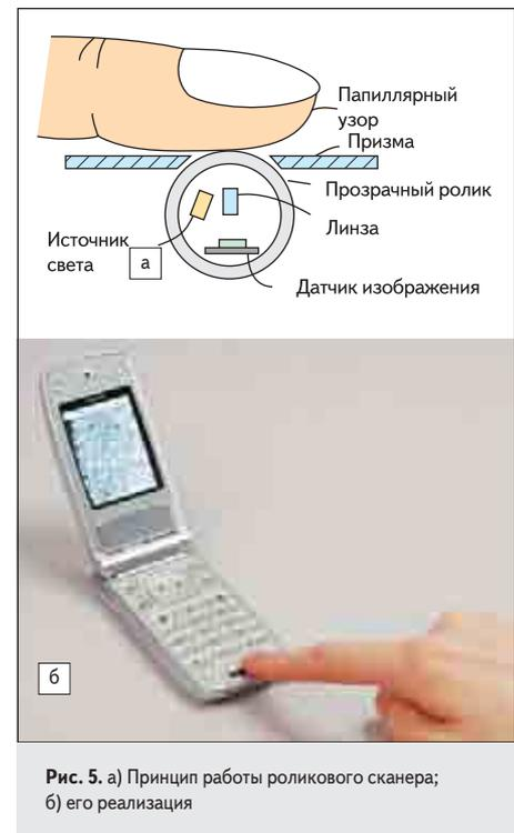
Рис. 5. а) Принцип работы роликового сканера; б) его реализация
