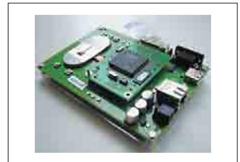
Рис. 14. Набор разработчика AT77SM0101BCB02VEK
