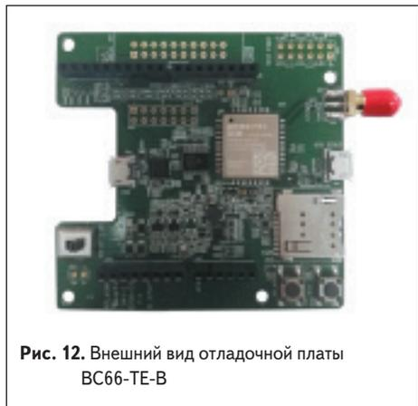
Рис. 12. Внешний вид отладочной платы BC66-TE-B
