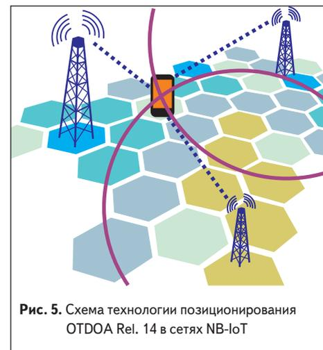
Рис. 5. Схема технологии позиционирования OTDOA Rel. 14 в сетях NB-IoT
