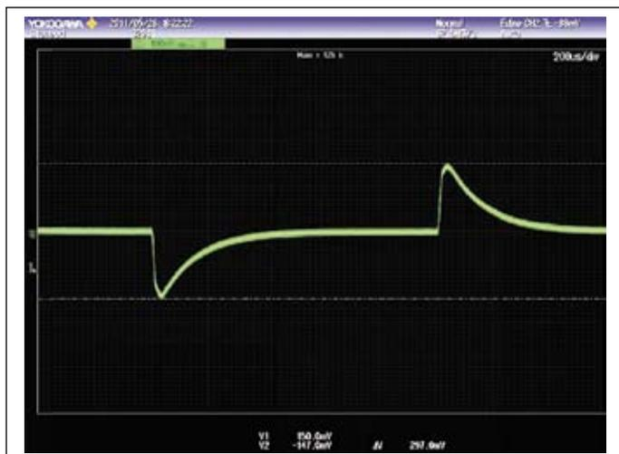
Рис. 8. Типичные изменения выходного напряжения при ступенчатом изменении нагрузки от 5 до 10 А и от 10 до 5 А для GH2805S (выходное напряжение 5 В)
