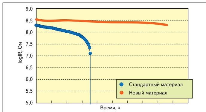
Рис. 5. Результаты ускоренных высокотемпературных испытаний под нагрузкой (20 В/мм, 105 °C)
