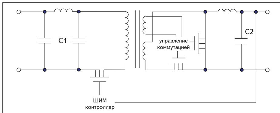
Рис. 1. Пример электрической схемы изолирующего DC/DC конвертера
