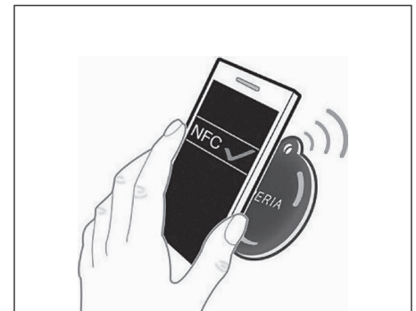
Рис. 2. Считывание данных NFC-метки с помощью смартфона, оснащенного NFC-интерфейсом
