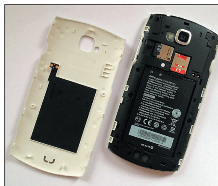
Рис. 12. Интеграция NFC-интерфейса в заднюю крышку смартфона
