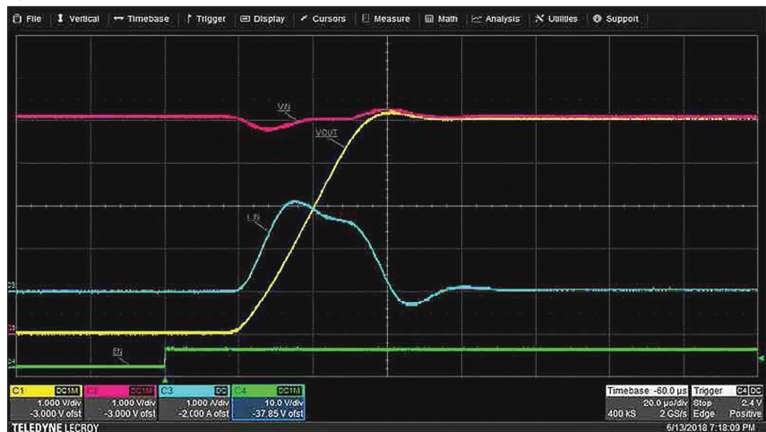
Рис. 4. Срабатывание функции FRS ключа AOZ1356LI: EN_to_Ramp_Delay = 20 мкс, время линейного нарастания = 40 мкс, общая задержка = 60 мкс, I IN peak = 2,1 А
