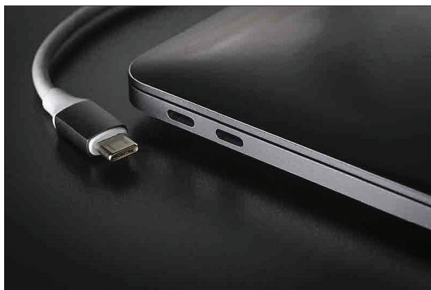
Рис. 1. Разъемы USB-C, предназначенные для компактной промышленной продукции, поддерживают требования многих стандартов к электропитанию и сопряжению
