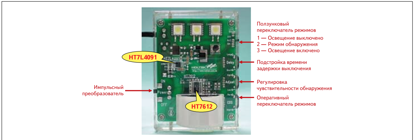
Рис. 11. Конструкция прибора обнаружения Holtek
