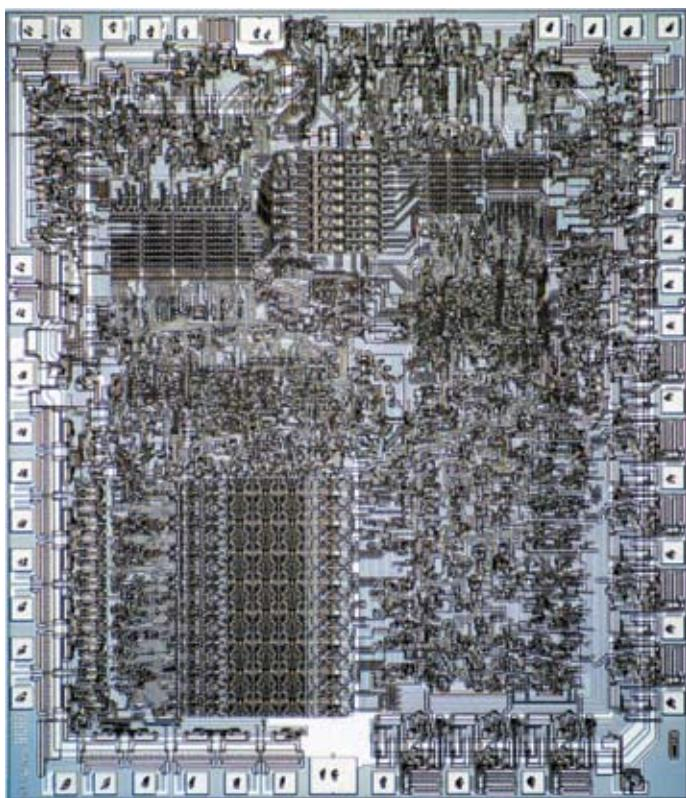
Рис. 1. Вид микропроцессора семейства 8080
