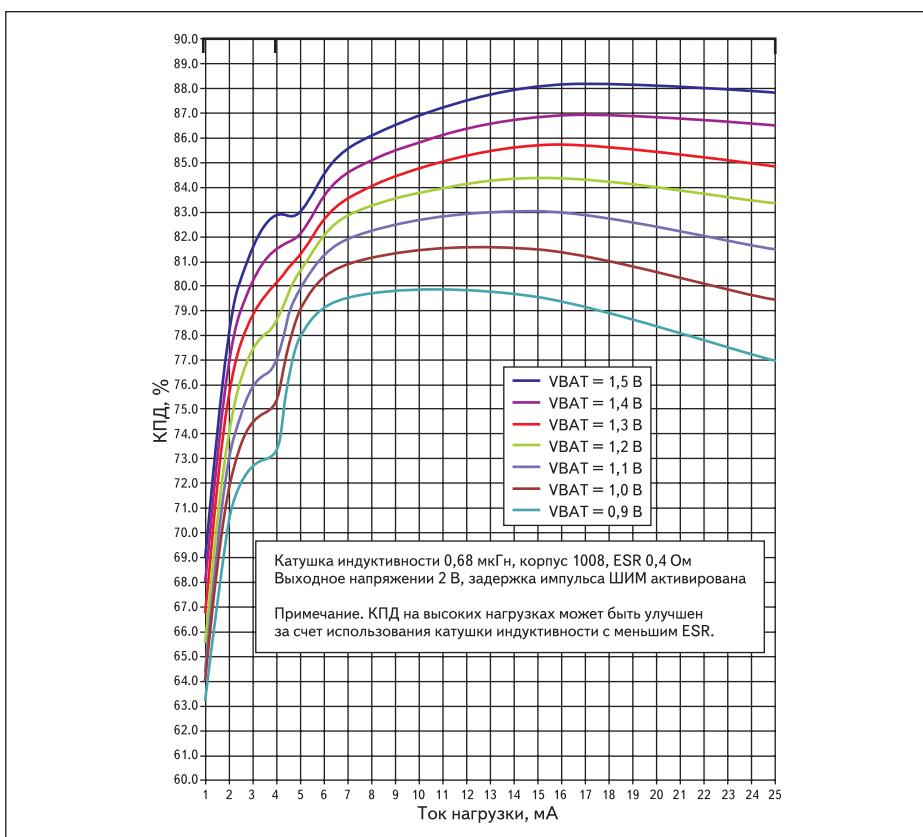
Рис. 6. КПД DC/DC-преобразователя при выходном напряжении 2 В
