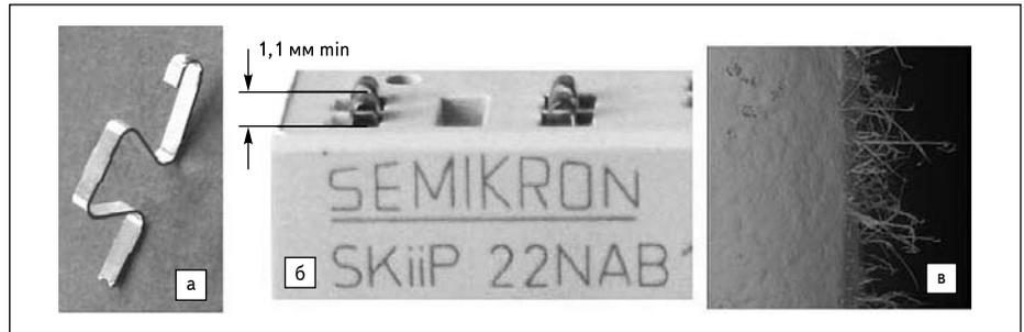
Рис. 2. а, б) Пружинные контакты MiniSKiiP; в) нитевидные кристаллы на поверхности пружины
