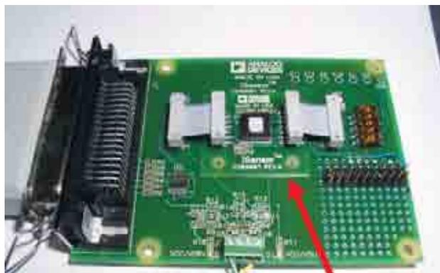
Рис. 8. Интерфейсная плата ADISEVAL с присоединенной отладочной платой ADIS16201/PCB (показана красной стрелкой)
