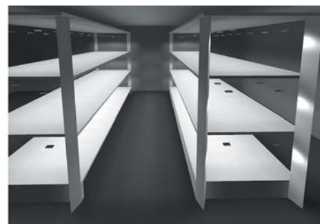
Рис. 17. Освещение стеллажа (результаты расчета E_{ср} = 8080 лк, E_{мин}/E_{ср} = 0,63 ; PPFD = 149 мкмоль/с/м 2 , \Phi AP = 26 Вт*/м 2 )
