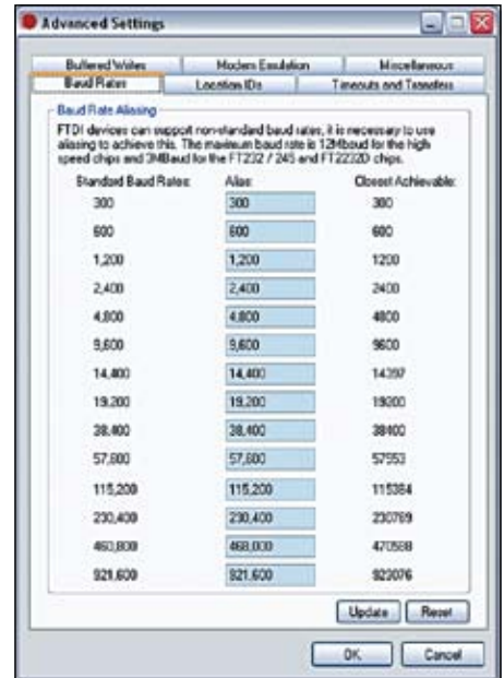
Рис. 6. Окно утилиты INF File Generator, настройка скорости передачи
