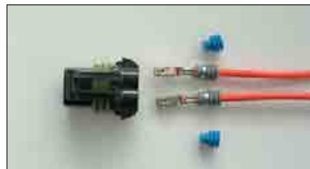
Рис. 2. Соединитель с индивидуальными уплотнителями
