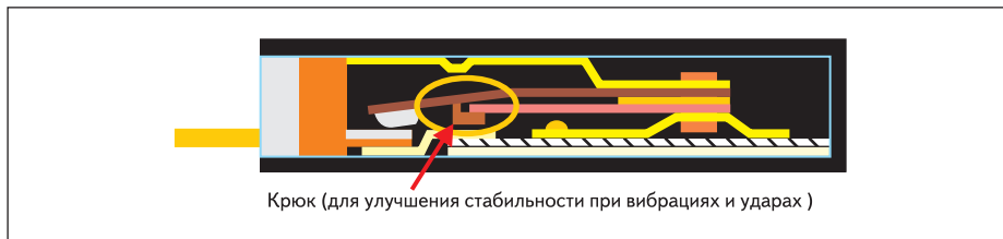
Рис. 7. Конструкция устройства МНР
